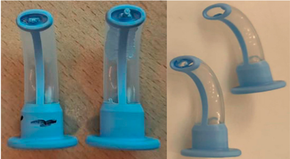
Ejemplo del defecto de fabricación observado en las Cánulas Guedel.
